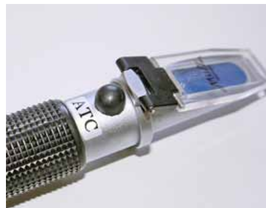
Refraktometer mit der Kennzeichnung ATC (Automatische Temperaturkompensation) müssten bei verschiedenen Temperaturen immer die gleichen Messwerte anzeigen – doch tun sie es tatsächlich? Foto: J. Schwenkel
