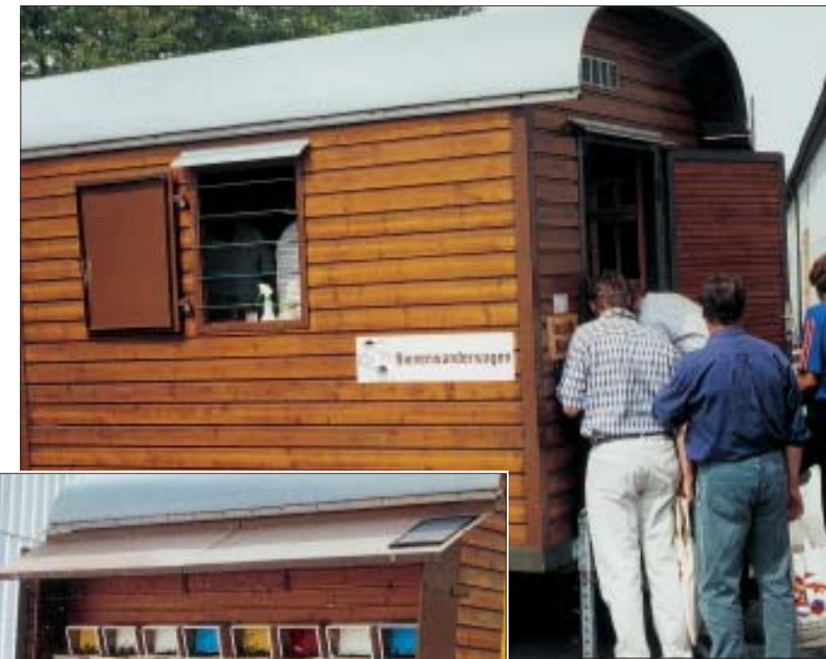
Einachsiger Wanderwagen, mit 16 Hinterbehandlungsbeuten belegt. Die Lichtzuführung erfolgt durch Fenster und Tür.
